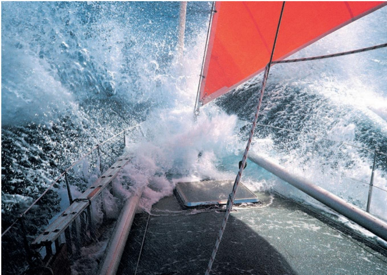
Das Sturmsegel wird mit Stagreitern an einem eigenen Stag gesetzt. Die Genua bleibt eingerollt und muss nicht geborgen werden
